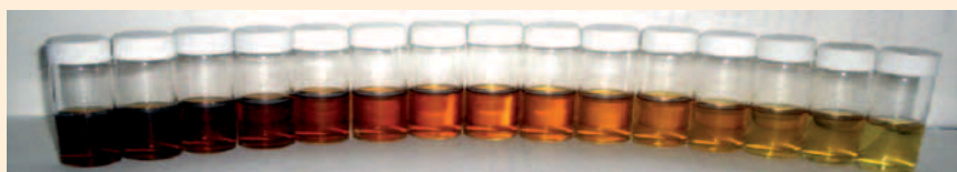
FIGURA 6. Efecto de la concentración de nanopartículas de plata de un mismo radio sobre el color. Las concentraciones son 47.7, 42.9, 33.4, 28.6, 23.9, 21.5, 19.1, 16.7, 14.3, 13.1, 11.9, 9.5, 7.2 y 4.8 \mu\text{g}/\text{m}^3 , de izquierda a derecha. Imagen tomada de Chhatre y colaboradores (Chhatre et al. , 2012).
