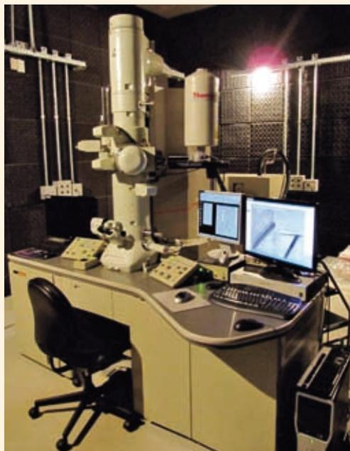
**IMAGEM 3.** Sistema Nanolito, que permite fabricar objetos nanométricos mediante técnicas de litografia com feixe de elétrons baseado num Microscópio Eletrônico de Varredura (STM), no Laboratório Multiusuário de Nanociência e Nanotecnologia (LABNANO), instalado no Centro Brasileiro de Pesquisas Físicas (CBPF/MCT), que está localizado na cidade do Rio de Janeiro. Foto disponível em <<http://portal.cbpf.br/index.php?page=Noticias.VerNoticia&id=394>>.
