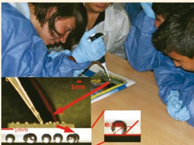
En esta actividad, los aprendices se familiarizan con mediciones de ángulos de contacto de gotas de agua sobre las muestras, ángulos mayores de  $90^\circ$  representa hidrofobicidad y menores a  $90^\circ$  hidrofilia (aceptación de agua de un material).
