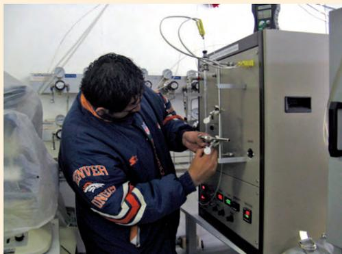
**IMAGEN 4.** Sistema de Micro-reacción RIG-150 instalado en el LMN del CCADET, operado por un estudiante de la maestría en ingeniería química de la UNAM.
