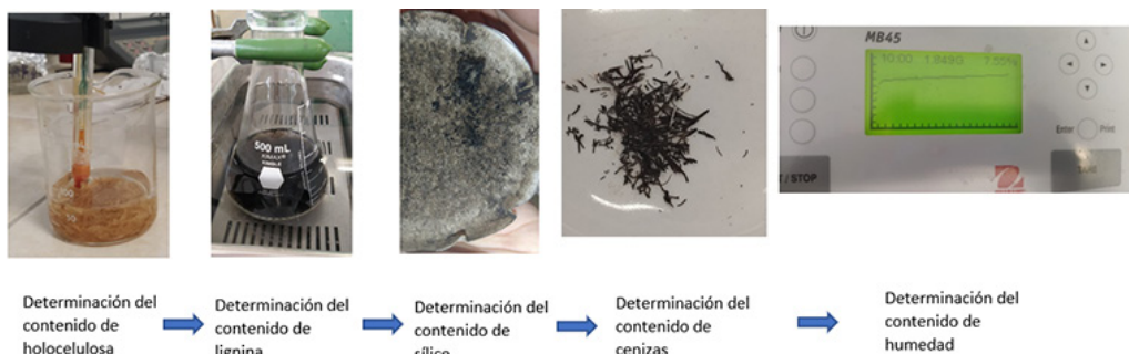
Figura 1. Procedimiento llevado a cabo en el Dpto. DEPI del Instituto Tecnológico Zacatepec (ITZ), para caracterizar la cascarilla de arroz Var. "Morelos A-2010 con la que se obtuvo la celulosa.
